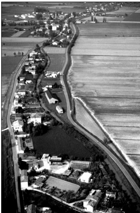
Fig. 2 - La foto aerea obliqua mostra l'Adigetto presso Buso, nello sfondo. Le due strade appaiate evidenziano i primitivi argini dell'antico ramo dell'Adige, all'interno dei quali scorre l'attuale corso d'acqua.
